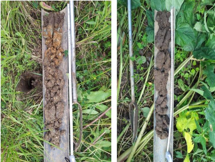
**Figure 7.** Photographies des différents types de sondages – A gauche : Sondage pédologique effectué sur remblai en partie bariolé, à conclusion indéterminée – A droite : Sondage pédologique non-humide effectué sur horizons plus naturels – Photos prises sur site - © Biotope (2021)
